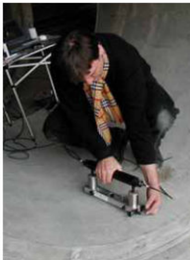
medición de la velocidad de onda P por método superficial
